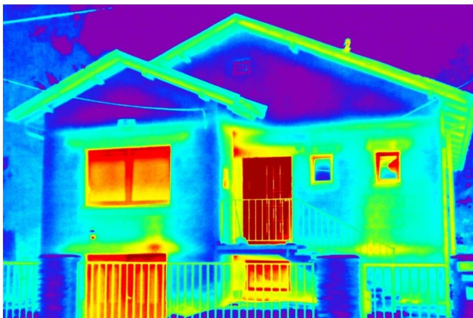
PREGLED HIŠE S TERMOKAMERO. VIR: HTTP://INFORMATION-SLOVENIA.COM/LENDVALENDVA-9220/OBRT-IN-STORITVE/PREGLED-STAVB-S-TERMO-KAMERO-TERMOGRAFIJA-STAVB/2015 .
