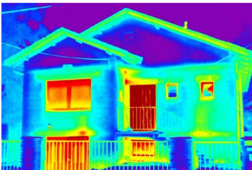
PREGLED HIŠE S TERMOKAMERO. VIR: HTTP://INFORMATION-SLOVENIA.COM/LENDVALENDVA-9220/OBRT-IN-STORITVE/PREGLED-STAVB-S-TERMO-KAMERO-TERMOGRAFIJA-STAVB/2015
