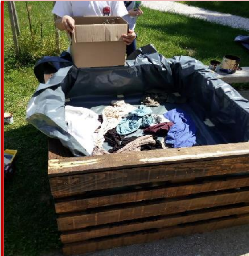
Polnjenje konstrukcije – nalaganje 1. plasti (oblačila)
