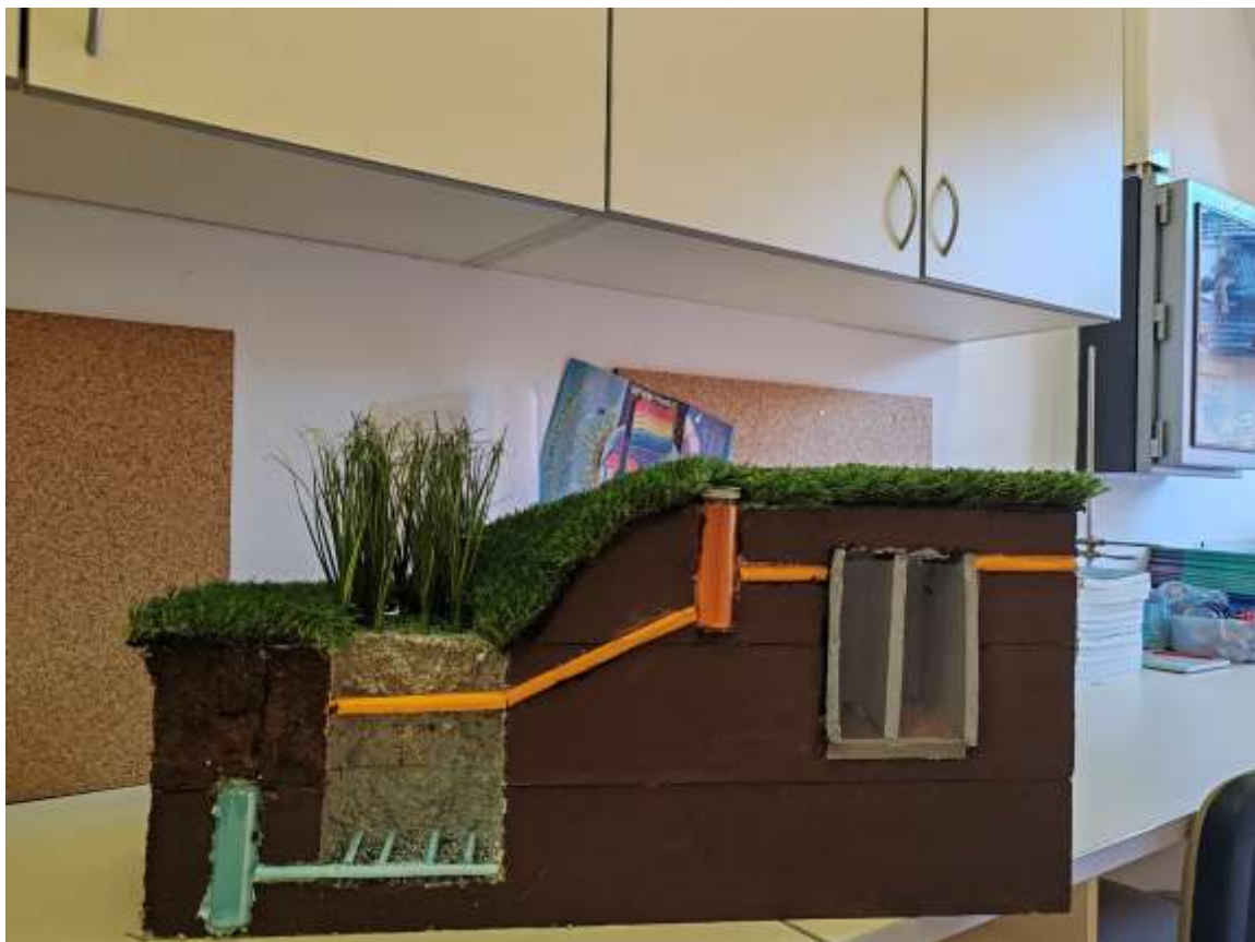
Slika 15: Maketa rastlinske čistilne naprave
