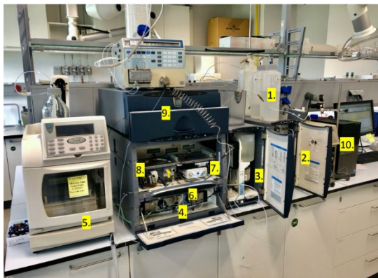
Figure 51: Ionski kromatograf, s katerim smo izvedli ionsko kromatografijo. (posnel: Gregor Marolt).
