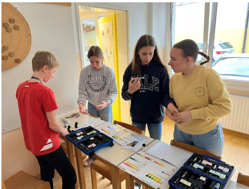
Slika 6: Določanje nitratov in nitritov s pomočjo kovčka za analizo vode.
