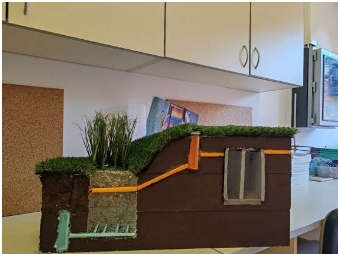
Slika 15: Maketa rastlinske čistilne naprave
