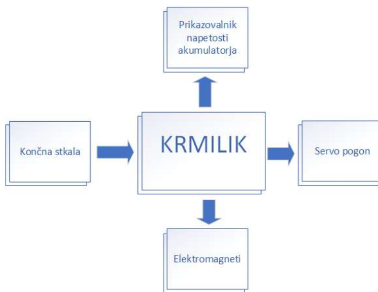
Slika 13: Blokovna shema bionskega čistilca magnetnih tabel
