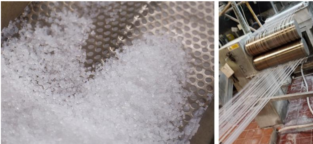
Slika 6: Izdelava granulotov in vlaken
