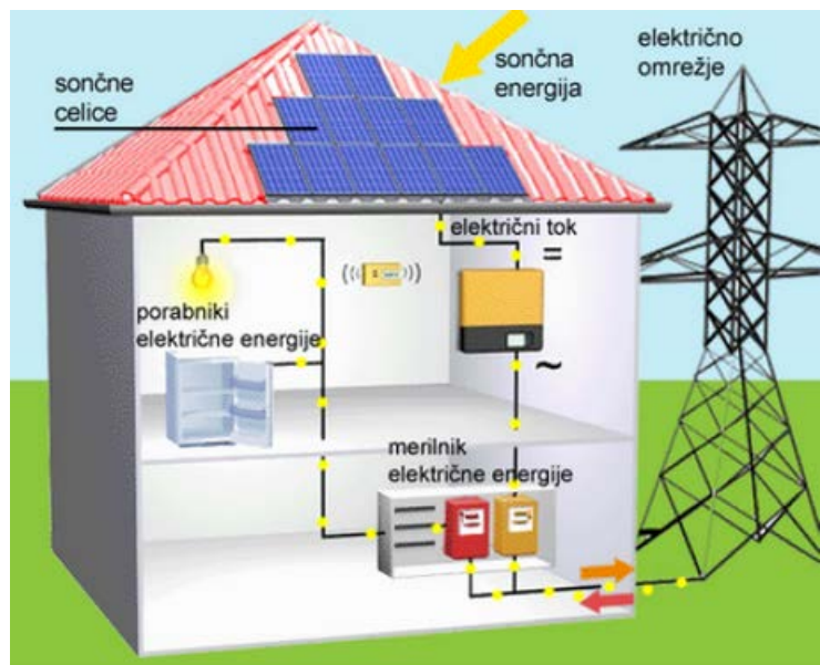
Slika prikazuje pretvarjanje sončne svetlobe v el. energijo Vir: https://eucbeniki.sio.si/nar6/1215/index5.html
