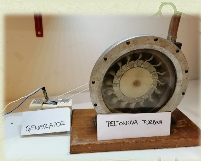
Hidroelektrarna s Peltonovo turbino
