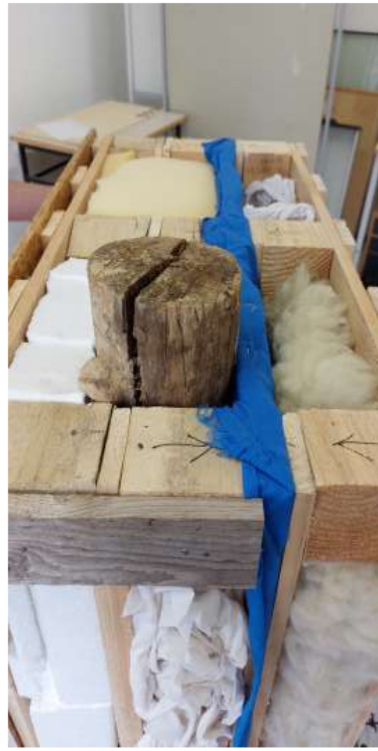
Prikaz fasadnega modula, ki obsega paletni element z integriranim nosilnim konstrukcijskim elementom in toplotno izolacijo.
